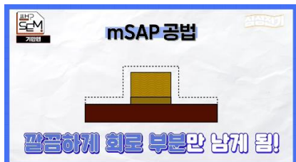
[그림 54] 필름을 날리는 MSAP 공법
